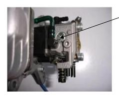
1、拆下该螺钉、打开化油器 后盖。
